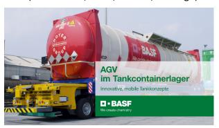
Den Transport vom Tankcontainerlager zu den Betrieben übernimmt ein fahrerloses Förderfahrzeug. Der Fachbegriff ist Automated Guided Vehicle oder kurz AGV. Es kann auf normalen Straßen fahren – autonom oder automatisch. Das Fahrzeug ist elektronisch mit einer Transponderspur verbunden und findet so zentimetergenau seinen Weg.
